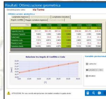
Gli strumenti di supporto tecnico-normativo di ROTOR risultano fondamentali durante tutte le fasi di progettazione, dalla bozza alla modifica della rotonda ed aiutano il progettista, anche se non esperto di mobilità, a razionalizzare il progetto della rotonda.
